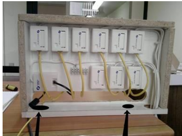
AGUJERO PARA LA PASADA DEL CABLE POWER ONT, CABLE AC DEL SWITCH (OPCIONAL) Y PIGTAIL
